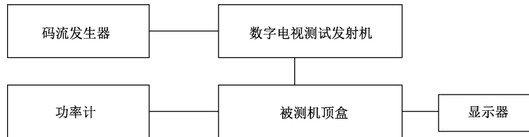
图 C.1 有线、地面和卫星机顶盒功率测试接线示意图
